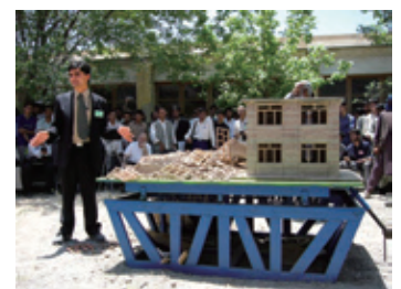
アフガニスタンでの建物模型（耐震補強ありなし）の振動台実演
